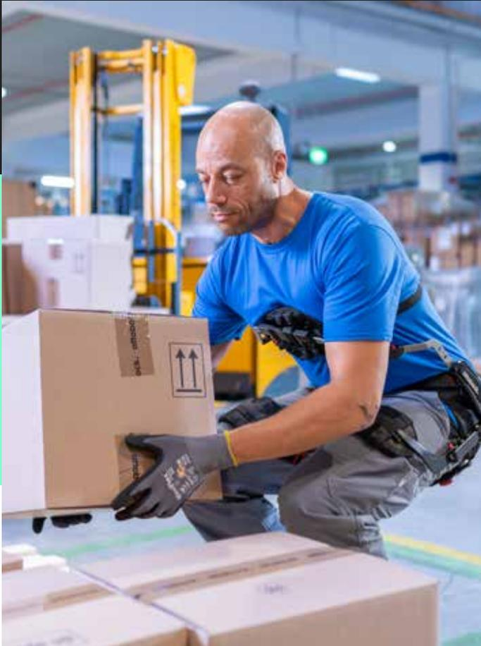
L'ultimo esoscheletro SUITX Back Air è perfetto per muovere carichi manualmente mantenendo un alto livello di flessibilità: riduce notevolmente il carico sulla parte bassa della schiena durante il sollevamento di oggetti. Allo stesso tempo, permette un alto grado di libertà di movimento, ad esempio, operare un carrello elevatore, lavorare in spazi stretti (container) o salire le scale.
