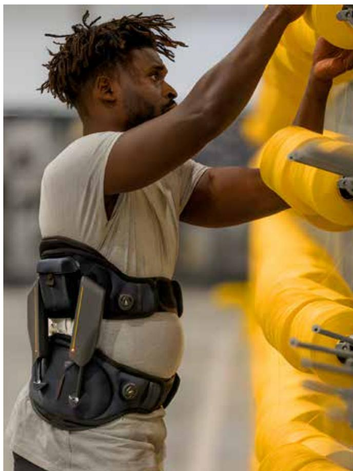
Prodotto dall'azienda francese Japet Medical, l'esoscheletro Japet W+ è un esoscheletro attivo molto particolare: è una fascia lombare con 4 cilindri che si espandono attivati da una batteria mettendo in trazione le vertebre lombari. In questo modo la pressione derivante dalla movimentazione dei carichi e gravante sul rachide lombare viene ridotta con grande beneficio per l'operatore.
