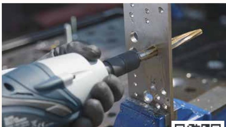
Ideali per allargare fori di piastre in acciaio al carbonio e/o per far passare i bulloni durante l'assemblaggio in modo sicuro e veloce anche con avvitatore a massa battente. Fori da 14 a 22 mm di diametro.
