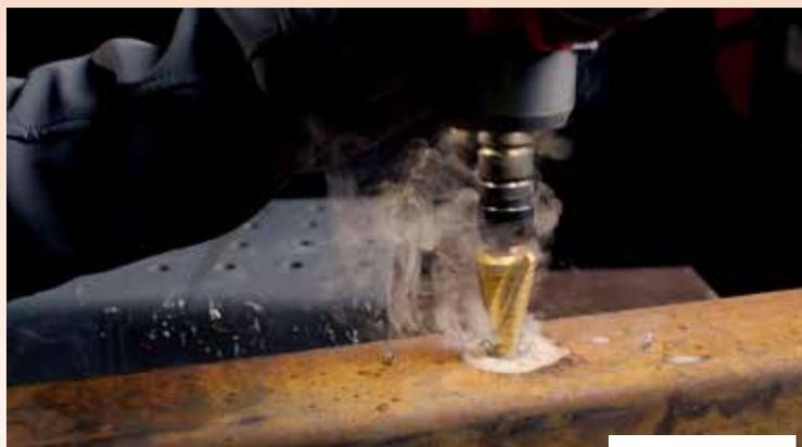
Ideali per forare piastre di acciaio al carbonio di spessore max. 5 mm in modo veloce, sicuro e senza bloccare il pezzo anche con avvitatore a massa battente. Fori da 4 a 30 mm di diametro.
