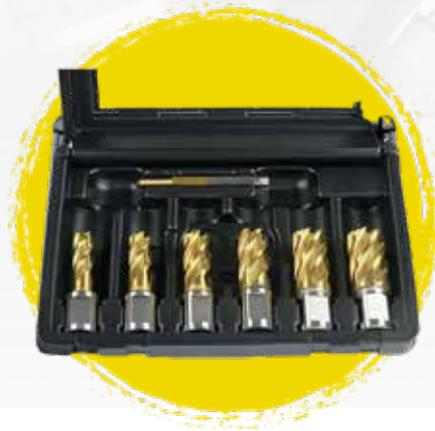
Cod. 490145TiN - Ø 12, 14, 16, 18, 20, 22 mm + perno di espulsione. Profondità di taglio: 30 mm. Portautensile Weldon 19 mm, elevata resistenza all'abrasione e bassa reattività, lunghissima durata.
