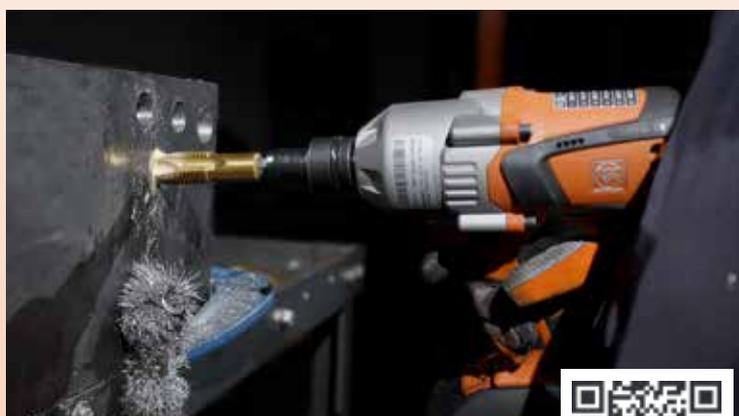
Ideali per maschiare o ripassare filetti verniciati da M6 a M16 su acciaio al carbonio in modo veloce e sicuro anche con avvitatore a massa battente.
